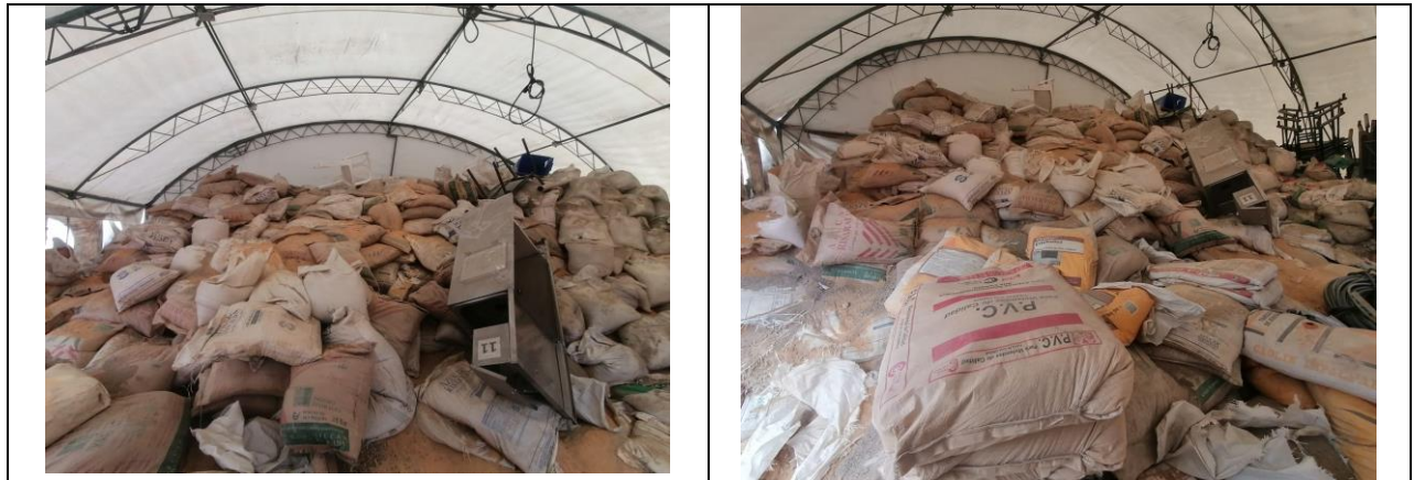
Descripción: Cemento vencido, arrumado en una carpa en el Complejo de Cazucá en recorrido durante el año 2022 y 2023
