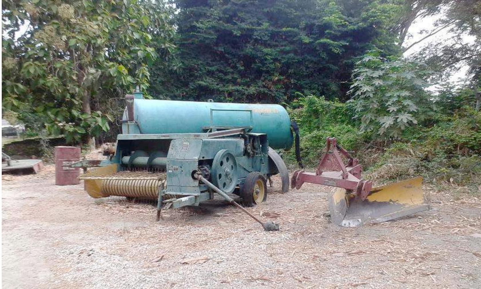
Maquinaria a la Intemperie sin mantenimiento preventivo ni correctivo en áreas de circulación
